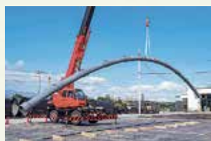
ダクタイル鋳鉄管は曲がっても 抜けないため、地震に強い
