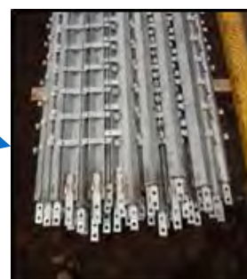
試行錯誤して汎用鋼材でのより集塵しやすい放電極を製作
