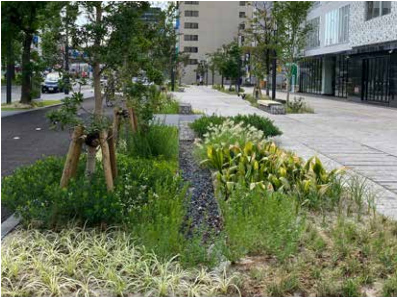
④ レインガーデンによる雨水流出抑制
