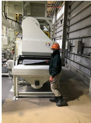
④ガラスが剥離されて出てくる。
