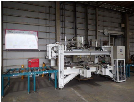
①フレーム外し機 ( ) この機会に太陽光パネルの外枠を外す
