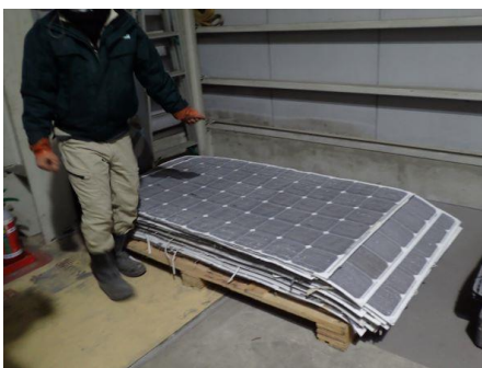
⑤ガラスがはがされたモジュール
