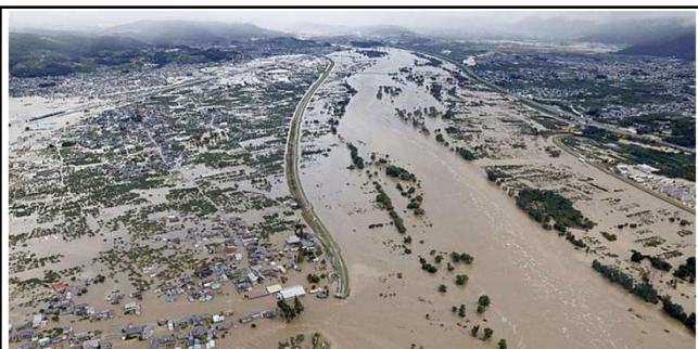
台風19号 長野県を流れる千曲川の堤防決壊により、流域で広範囲に浸水 BBCnewsJapan
