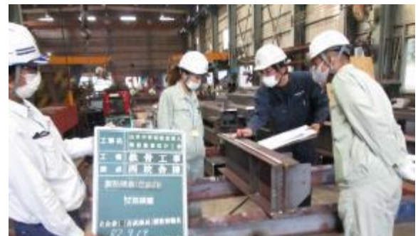
4. EV 棟の骨組み用鉄骨の工場検査
