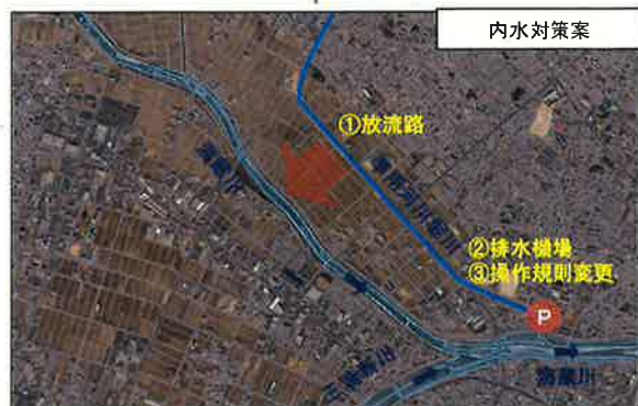
準用河川堀川における内水対策として ①放流路の設置 ②排水機場の設置 ③阿倉川樋門の 操作規則変更 を三滝川分派完成までに行います。
