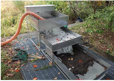
排水ホースの先に、流出防止ネットを設置する様子
