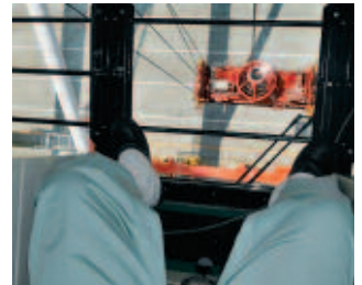
吊り具が揺れないように、操縦席を細かく前後に動かして制御します
