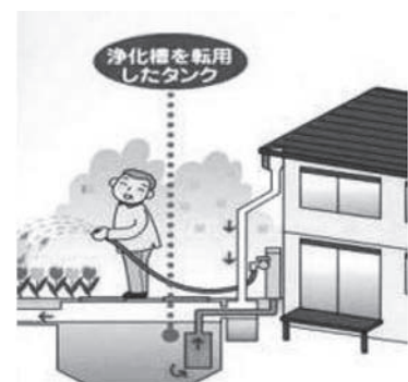
浄化槽を転用した雨水貯水槽のイメージ図
