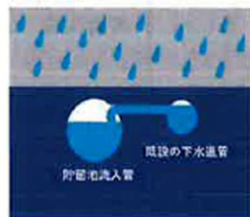
大きな雨が降ると、既設下水道管の能力を超えた雨水が貯留池流入管に流入します
