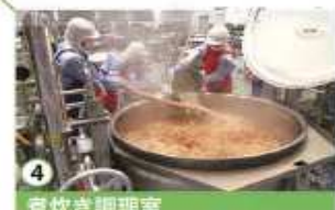
4 煮炊き調理室 蒸気式回転釜により、汁物や煮物等を調理します。
