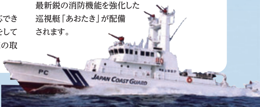
消防機能強化型巡視艇 (海上保安庁提供)
